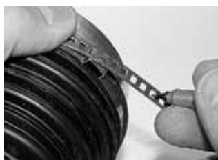
Paso 2 Determinar la longitud de la abrazadera. Comprobar que el final de la banda sobresale por encima de la oreja, tal como muestra la imagen.
