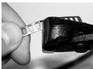
Paso 3 Cortar el material sobrante. Para evitar posibles lesiones desbarbar los cantos cortados con una lima.
