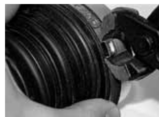
Paso 4 Colocar la abrazadera sobre la pieza. Enganchar el cierre en la posición más ajustada posible. Cerrar la oreja ade- cuadamente con una tenaza OETIKER
